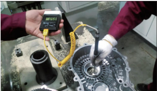
b) 大平面靠近左侧温度最高，达 96 ℃
