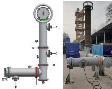
图11 252 kV GIS母线局放试验平台
