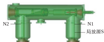
图4 合闸状态下断路器局放源与检测点位置示意图
