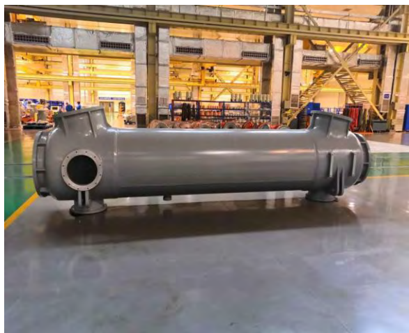
图1 550 kV GIS 隔离开关主体焊接结构图
