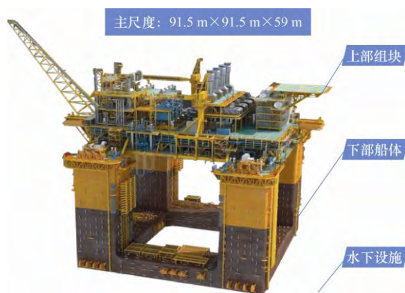
图1 南海某深水气田开发工程项目示意图
