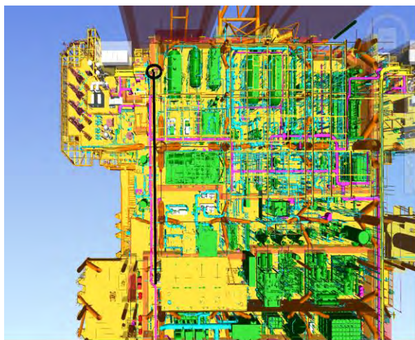
图2 3#立柱电缆预存放位置示意图
