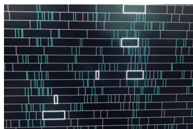
图 3 ECO 单元和附近的 Tie cell
