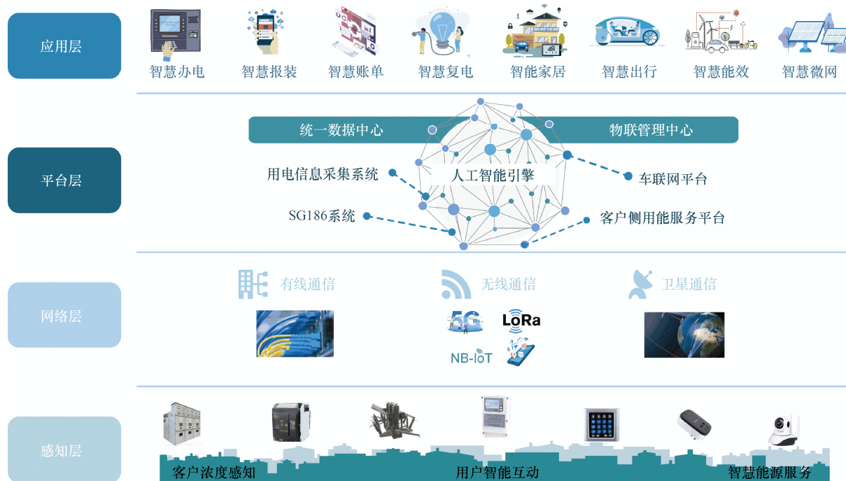
图3 客户侧低压泛在物联网的总体架构
