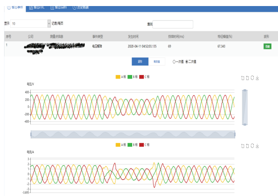
图 3 电压暂降检测仪运行界面
