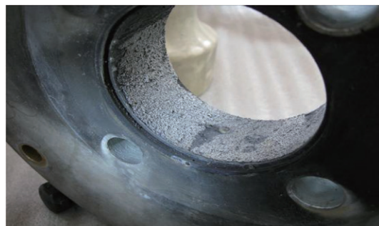
(b) 274开关支撑绝缘子地法兰放电点
