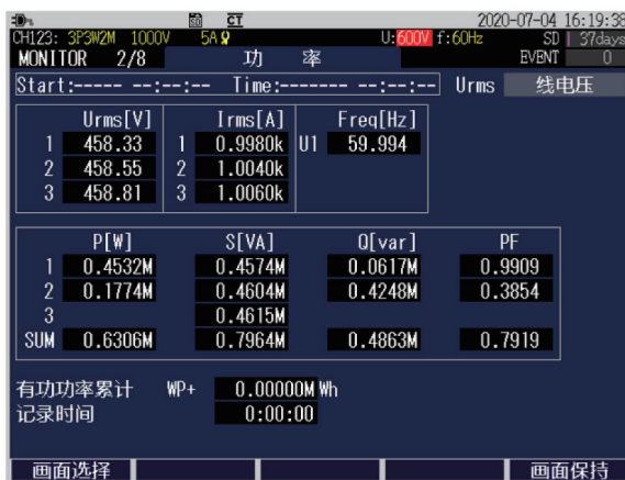
图5 第三组试验：加100%负载后
