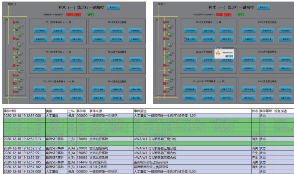
图8 7511开关带神木I线热备转运行试验记录图
