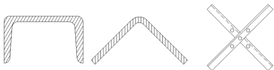
图3 免积水、积垢结构
