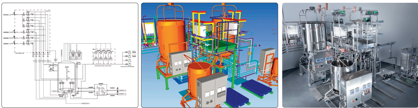
从管道及仪表流程图（P&ID）到成套制药设备都可以在数字双胞胎的 3D 模型中进行虚拟体验
