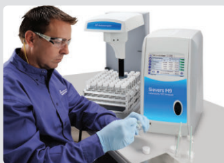
图 2 操作人员使用苏伊士 Sievers M9 实验室 TOC 分析仪进行清洁验证
