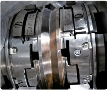
图8 采用新引线结构轴承和套环结构
