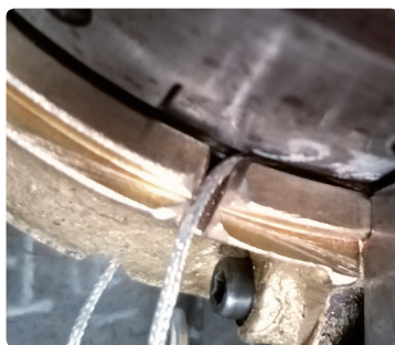
图 3 轴瓦组件相邻间隙小受到挤压
