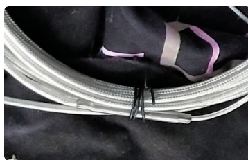
图 7 增加阻漏器功能的温度电缆
