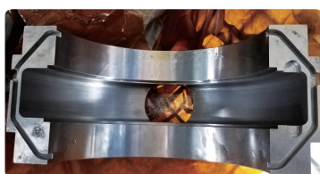
图 4 支撑瓦内部有凹槽可以顺线、无磨损和挤压
