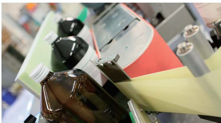
可以通过 Geset 全方位和侧面贴标系统对圆柱形的初级包装进行贴标
