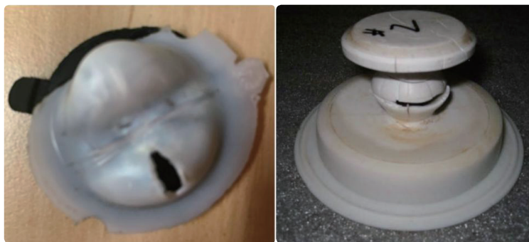
图 1 左：堰式双膜片中破裂的 PTFE/EPDM 隔膜层层间液体累积；右：与 CIP 添加剂发生兼容性问题的柱塞式隔膜
