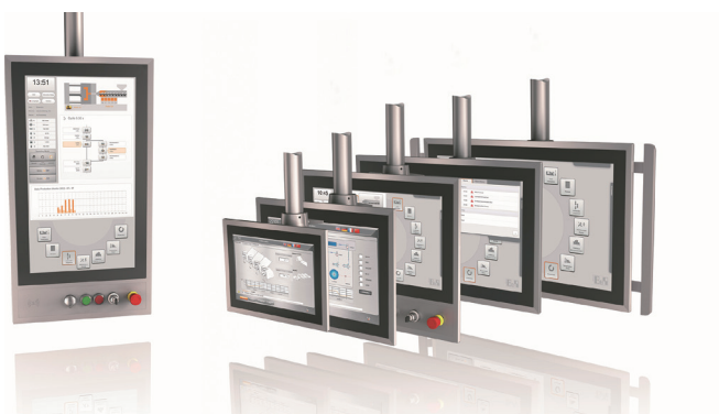
摇臂上安装了触摸屏面板，使得操作变得方便、直观
