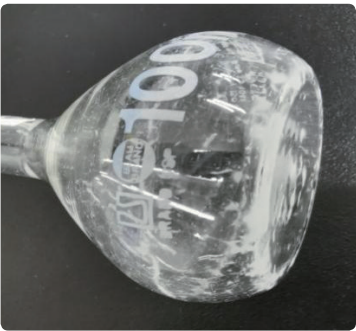
图 1 刻度标识磨损的容量瓶
