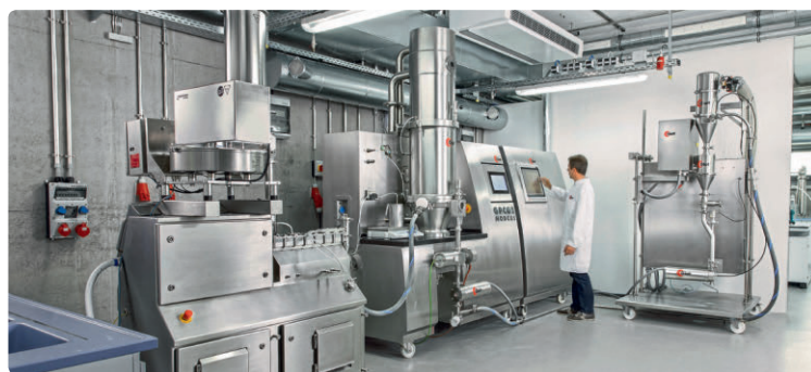
Glatt 的 Modcos 生产线的产能为 4 ~ 15 kg/h
