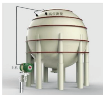
图 2 超声波液位开关在球罐高位的安装示意图
