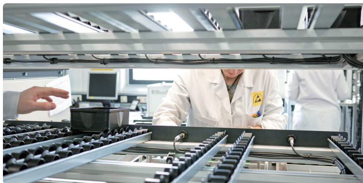
两个货架系统都可以从后面装入新元件，无需中断生产过程
