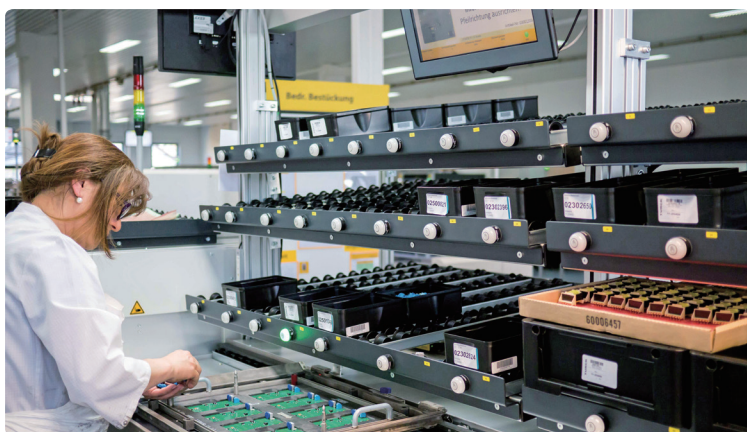
新型部件拾取指示灯更符合人体工学
