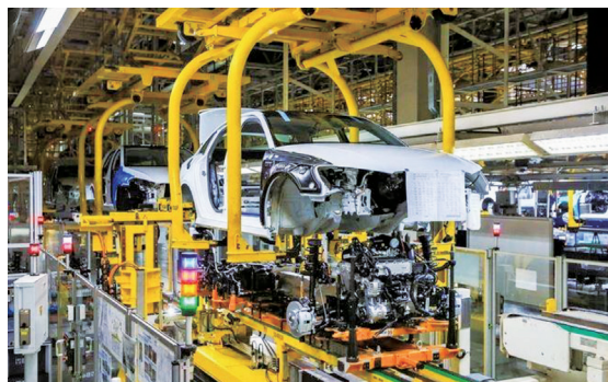
图 3 某主机厂举升机举升底盘式合车
