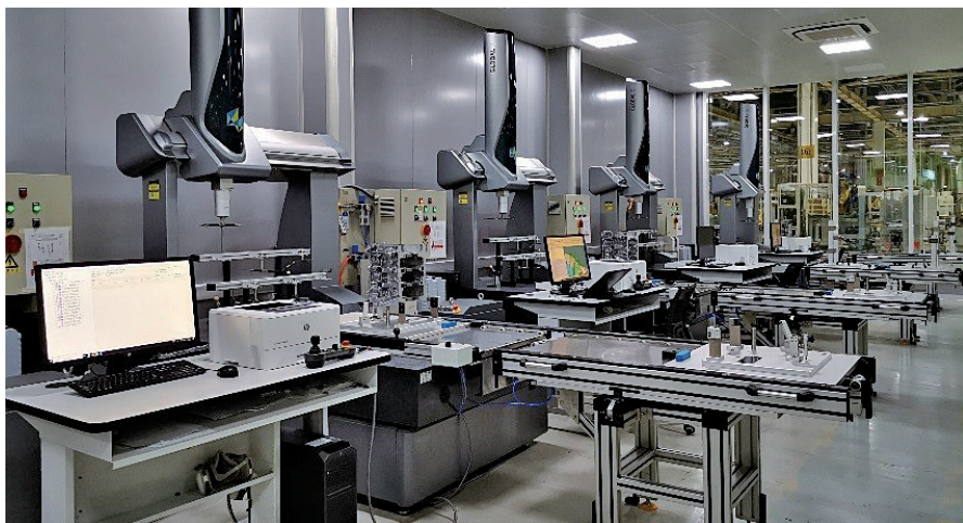
图 3 东岳基地三坐标测量现场
