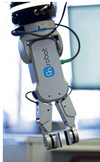
图 4 该团队与 Onrobot 和系统集成商 Fichtner 一起为研发了 RG2-FT 上的各种指尖。这些指尖使它可以更好地抓握手工玻璃样品
