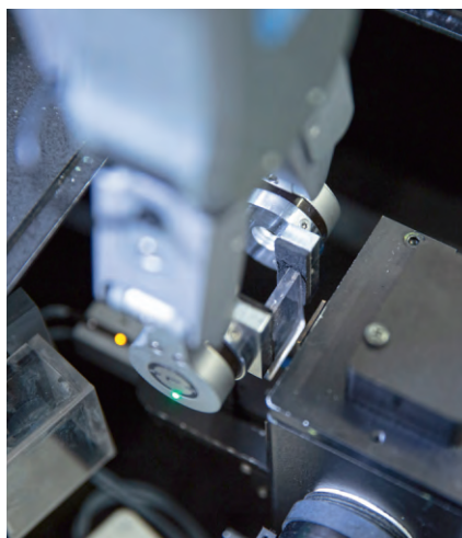
图 3 分光计检测玻璃的光学特性，从而发现生产错误
