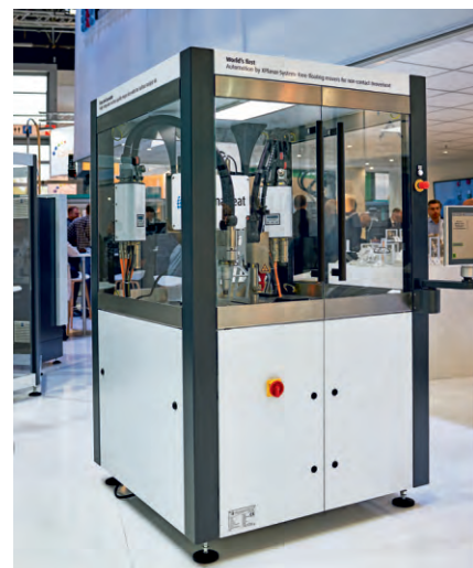
图 3 新的等离子体表面处理设备结构非常紧凑，因为它不再需要使用六轴机器人或额外的线性轴
