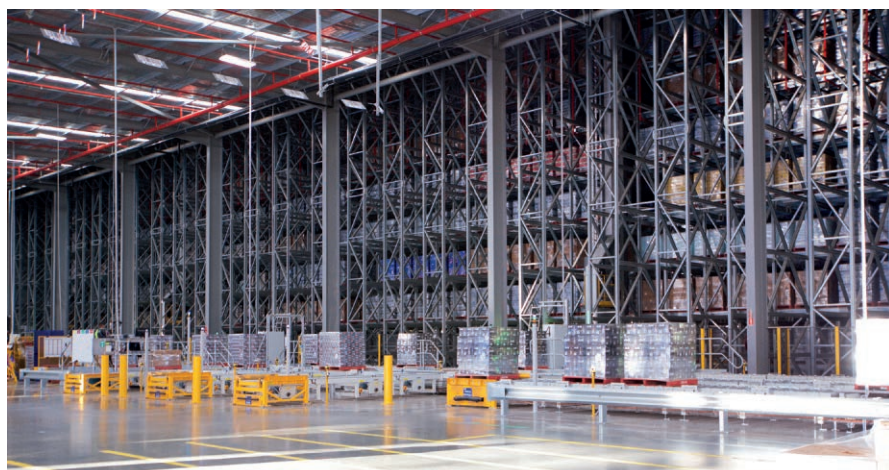
图 2 Dematic 公司为 Asahi Beverages 公司建造了一个全新的、拥有 31 500 个架口的 HRL 高级立体库，将物流中心的物资吞吐能力提高了 250%
