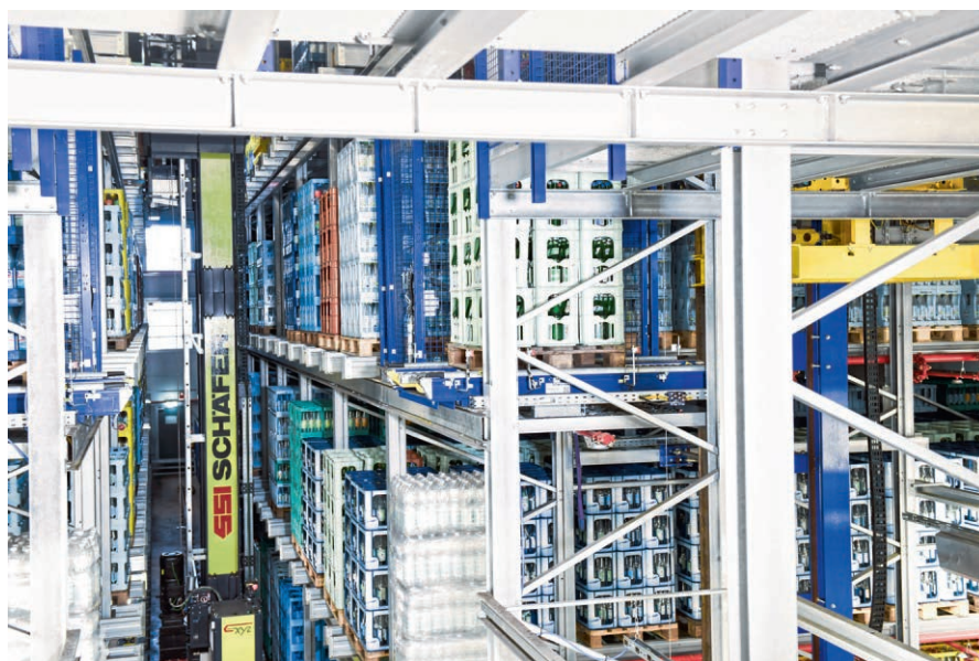
图 3 Exyz 型高架存取叉车（RBG）承担着在四层 HRL 高架立体库中存取物资的工作
