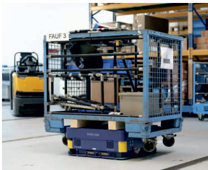
图2 开放式的架构可以使 Kinexon Brain 控制操作系统灵活方便地将不同生产厂家制造的 FTF 无人驾驶地面运输车集中在一起管理
