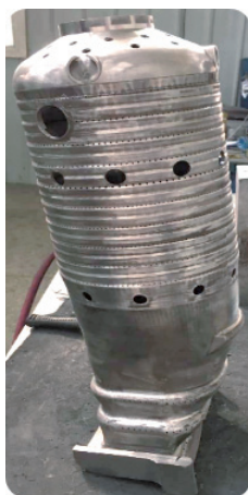
图 2 某型燃气轮机火焰筒
