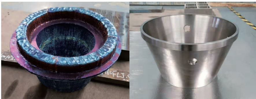
图1 Ti60 LENS成形法兰零件毛坯及成品
