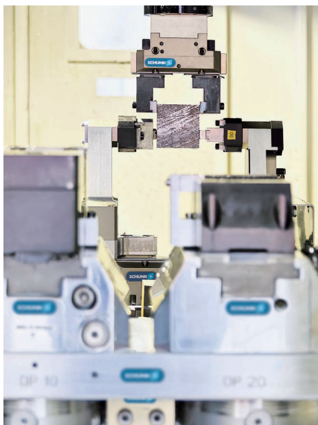
图 2 装载时，通过常规刀架固定到机器主轴上的 Schunk 通用抓手移至刀库，拾取一个水刀切割毛坯，然后将其放入夹紧块中
