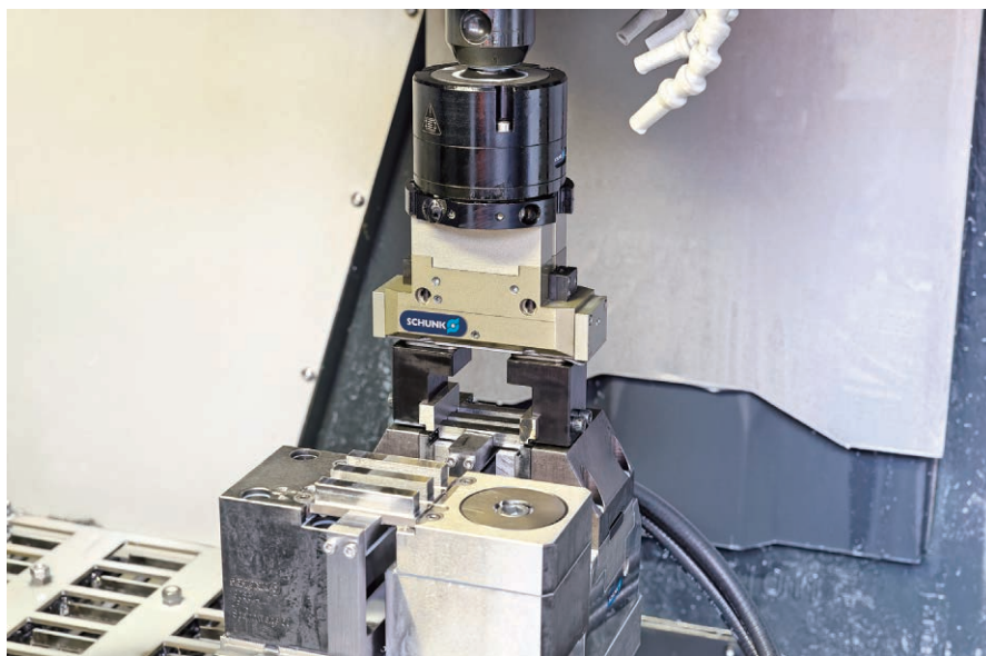
图 3 在完成最后一步加工操作后，三个样品被分开，然后一起打包，再被抓手取走送至指定的位置
