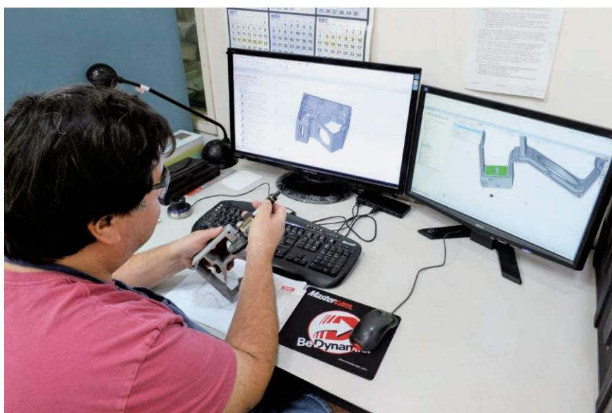
图 1 完成的设计方案可通过公司的网络以电子文档的方式提交给机械制造厂，导入 Mastercam® CAD/CAM 中，进行原型制作
