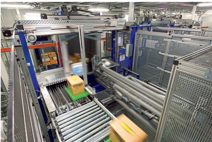
图 4 Witron 公司的 OPM 订单拣选系统已经在世界各地许多冷鲜食品配送中心得到了广泛的应用
