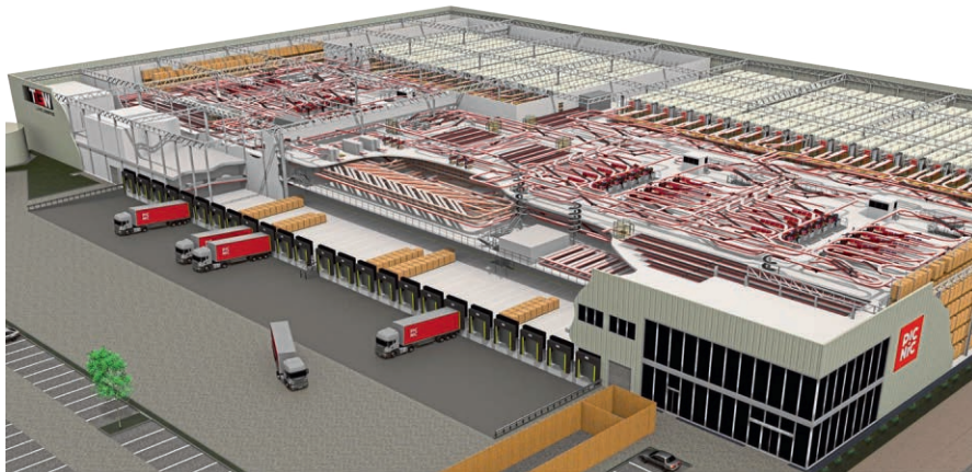
图 5 TGW 公司为 Picnic 公司物流配送中心提供的快速拣选配货解决方案的核心是一个有着 40 条通道、20 万托盘架口的穿梭式运输系统
