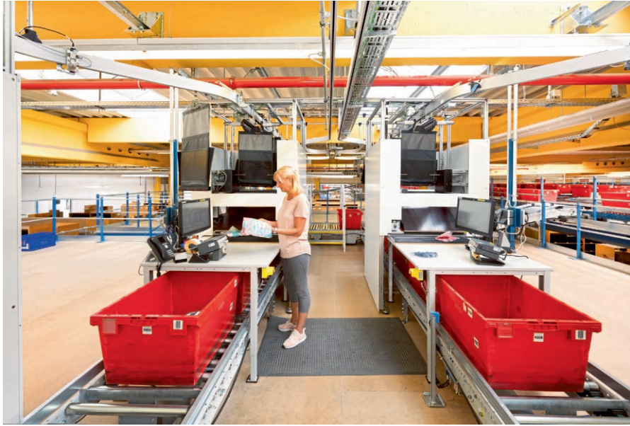
图 3 自动化悬挂式运输系统和辊道输送带可以将悬挂、平放和包装好的货物都纳入一个拣选配货系统
