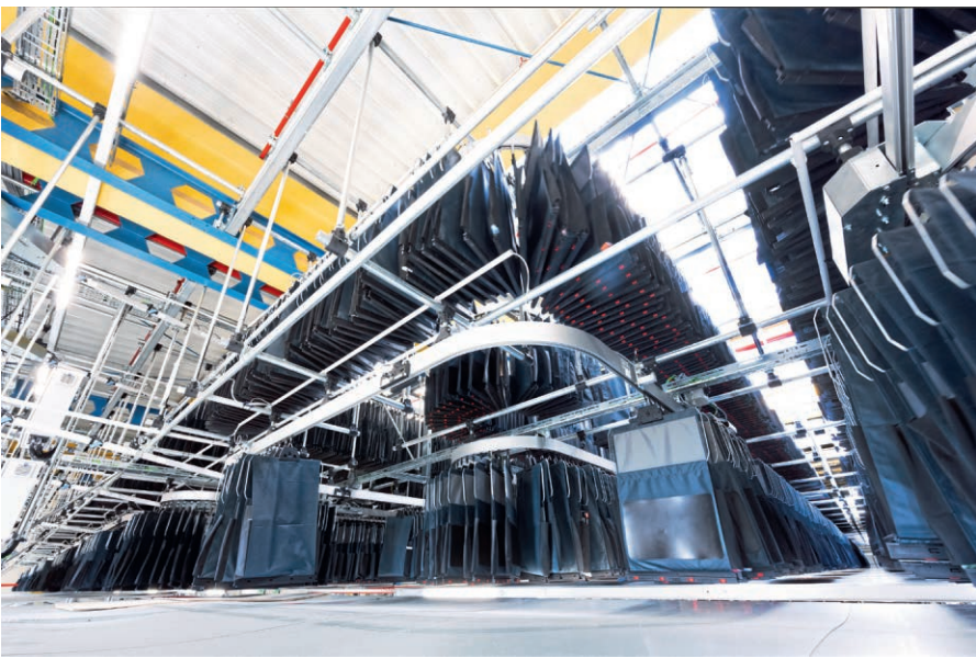
图 2 德马泰克袋式分拣配货系统给 Bad Rodach 市玩具生产厂的物流配货中心的电子商务提供了快捷和高效的技术支持
