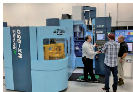
Matsuura 的 MX-850 是北美地区的新产品，它是自动化加工的典型示例，可代表许多车间进入夜间无人值守加工模式的一个切入点
