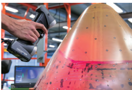
用于控制材料膨胀的 3D 扫描仪和摄影测量系统
