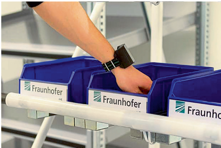
SmaRackT 研发项目中使用了感应式近场定位技术和机器学习技术来识别和跟踪企业内部的物料流
