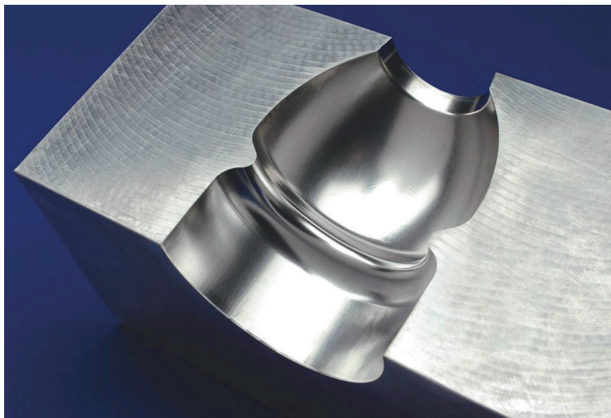
图 2 利用激光抛光工艺修复的压铸滑块。若用金刚砂手工研磨可能要耗费数小时的时间
