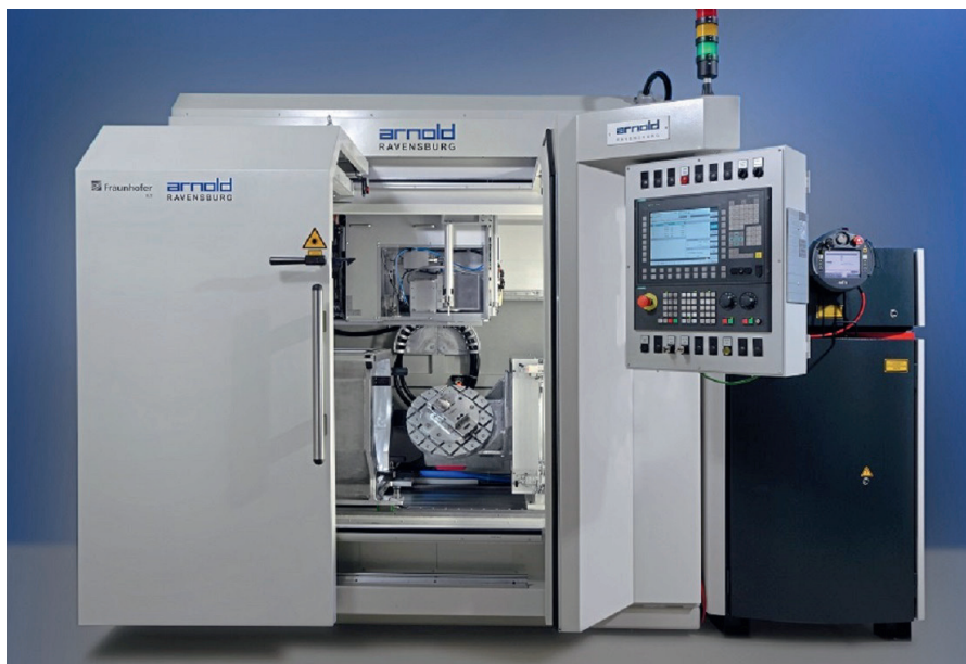
图 4 Ravensburg 市 Arnold 公司研发生产的、能够完成不同材质零件激光抛光的加工设备
