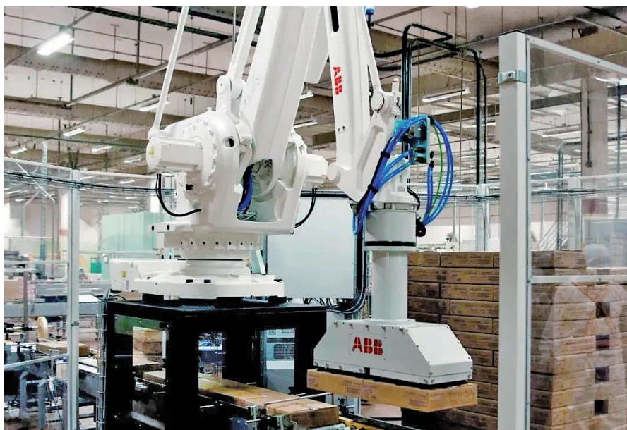
图 1 ABB 紧凑协作式机器人码垛单元
