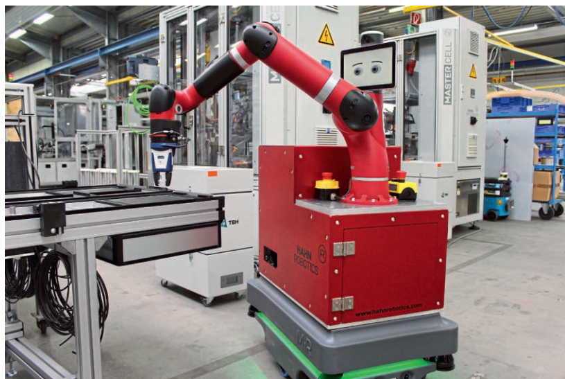
图 2 MiR 和 Sawyer 的移动机器人正在运行——移动机器人和协作机器人的结合实现了自动货物运输，也可以作为 RaaS 解决方案来实施
