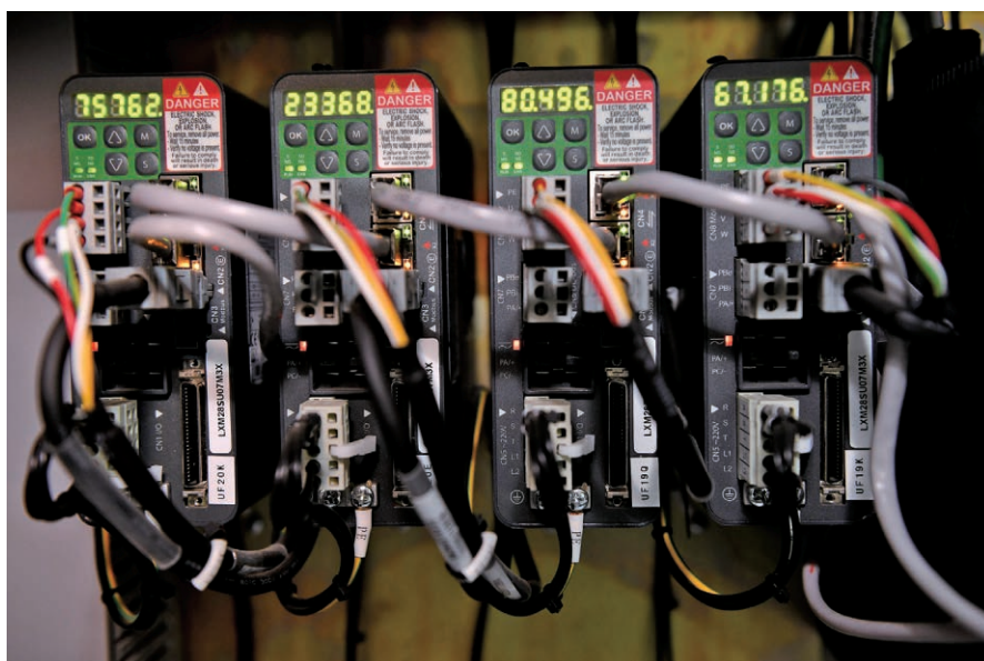
施耐德电气 Lexium28S SercosIII 总线型伺服驱动器
