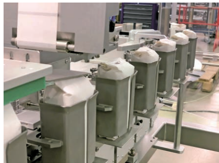
图 4 在 SuperTrak 解决方案中，只有滑块和装袋子的料盒是需要移动的。与传统链式输送系统相比，它的重量要轻得多，这意味着加速和制动所需的功率更少
