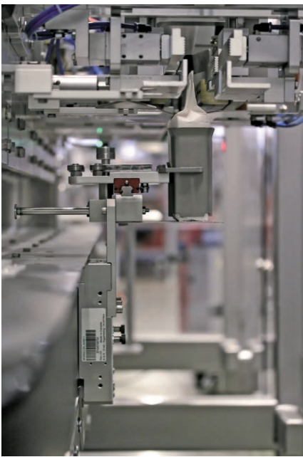
图 2 封口机的输送系统将每个袋子单独输送到加工工位
