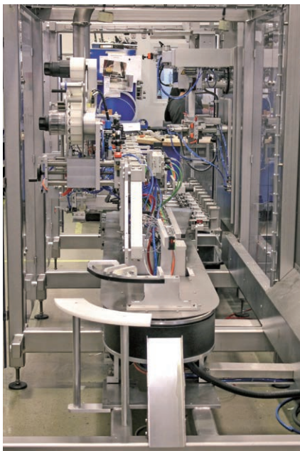
图 1 Wolf 公司通过基于贝加莱 SuperTrak 的柔性电驱输送解决方案开发了适合更高性能范围的封口机
