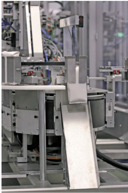
图 3 得益于可自由编程的运动曲线，设计人员在如何布置加工工位方面拥有更大自由度，而且可以根据需要跳过或添加工位
