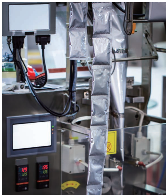
图2 立式包装机可解决卧式包装机包装封口挤压的问题，且包装快速、整齐
