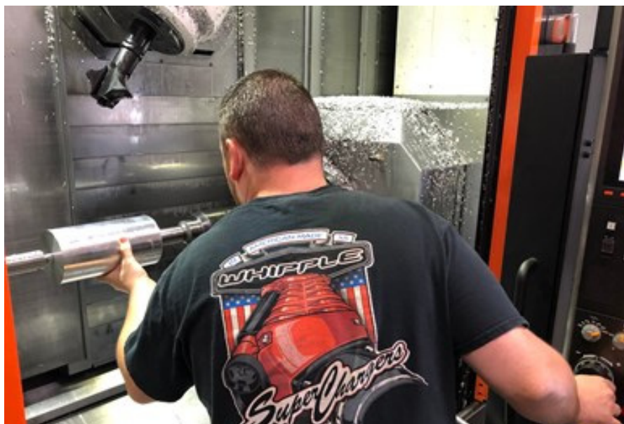
图 5 Chris Jensen 是这台机器的主要操作人员。凸转子的循环周期为 14 min，凹转子的循环周期为 20 min
