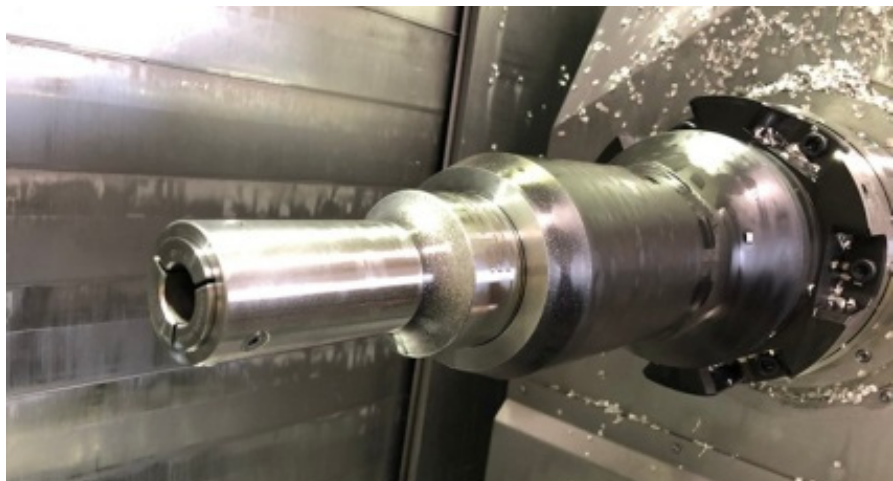
图 3 与以前使用的 ER 夹头不同，定长夹头不会向后拉动工件，也不会向主轴施加任何负载。这使得设置时间从 10 min 缩短到了 2 min
