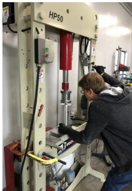
图 4 先对铝转子坯料进行钻孔，以便刚轴可以压入其中
