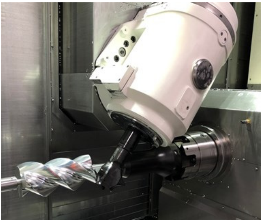
图 1 定制和成型工具确保 Whipple 的增压机可以在 B 轴车铣机上通过一次设置就可以精准打磨增压器转子
