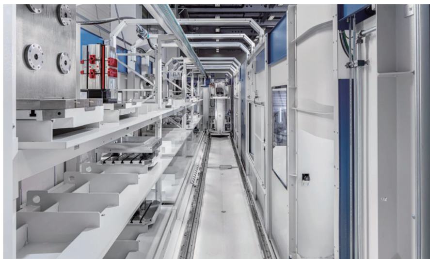
图 3 格劳博直线托盘存储系统 PSS-L 内部
