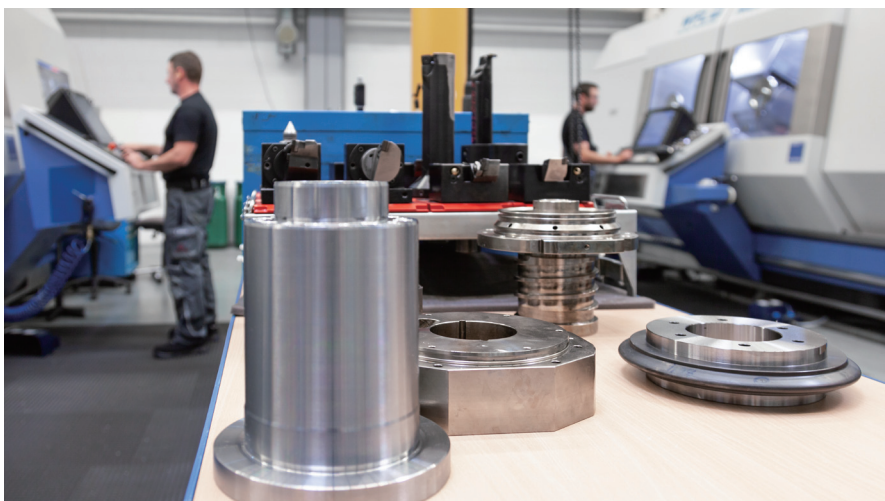
图 1 Kapp Niles 磨床组装所用的百余种不同零配件目前正在由两台 M40-G 车铣复合加工中心加工
