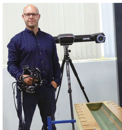
图 2 便携式三维扫描仪 MetraSCAN 3D
