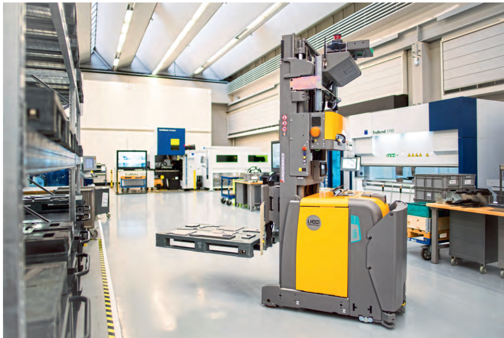
图2自动运输车将原材料输送到下一工位的折弯机那里。这就节省了操作者的时间，提高了钣金件的生产效率
