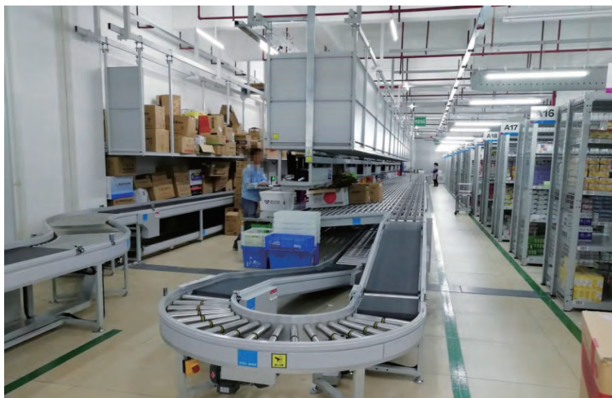
图3 复核分拣与空箱回流线
