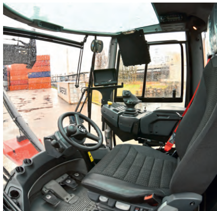
图3 装有空调设备的 EGO 型空箱堆高机驾驶室
