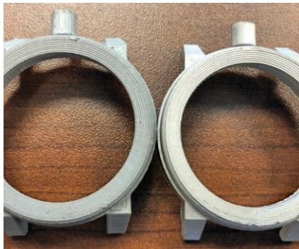
在 Desktop Metal（左）和 MarkForged（右）材料挤出成形系统上使用 17-4PH 不锈钢打印出来的 Vortic Watch 有限公司的表壳复制品
